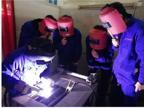
6mm 低碳钢板 V 型坡口平对接板
