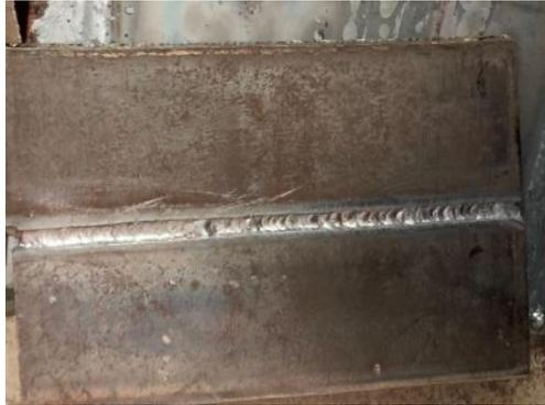
6mm 低碳钢板 V 型坡口横对接板
