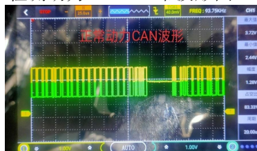
检测动力 CAN 正常波形图
